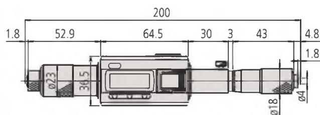
Микрометрическая головка для серии 337
